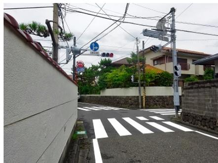
信号機は早朝、登校時、日中、下校時、夜、深夜と時間帯により、制御時間が異なっています。例を挙げると午前7時～9時は歩行者用信号機は23秒(点滅も含め)、その上の車両用信号機はプラス8秒で赤信号に変わります。対してバス通り側も31秒で赤に変わります(警察への要望で2020年4月より14秒間、待機時間が短縮されました)。その後、朝9以降は往来する人や車が減るので21秒(歩行者17秒)対37秒となり、下校時の13時～16時は29秒(歩行者23秒)対45秒と通行量に応じて切替られています。
